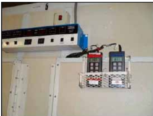
Figura 7: El sensor de calibración se debe colocar cerca del sensor de temperatura de la máquina.
