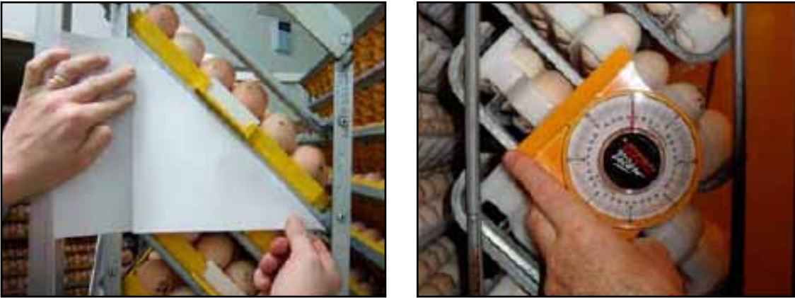
Figura 4: Verificación del ángulo de volteo.
