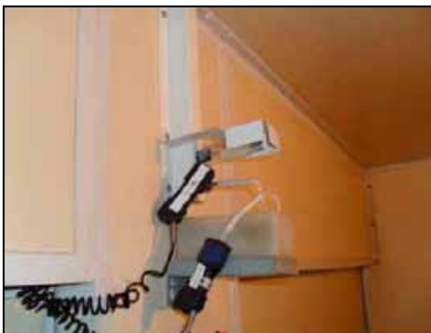
Figura 7: El sensor de calibración se debe colocar cerca del sensor de temperatura de la máquina.
