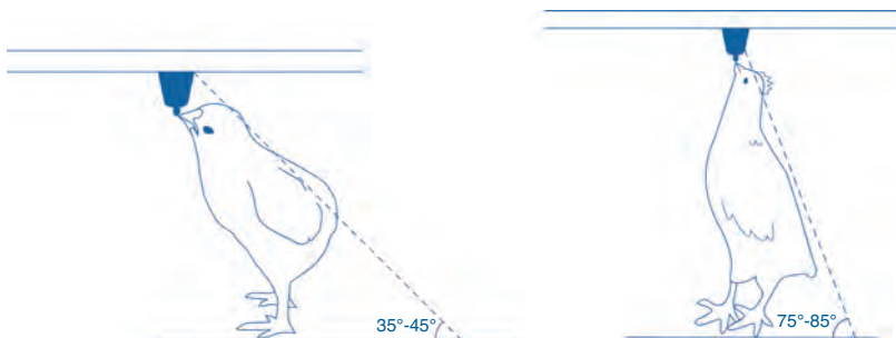
Obrázek 12: Nastavení výšky kapátkové napáječky
